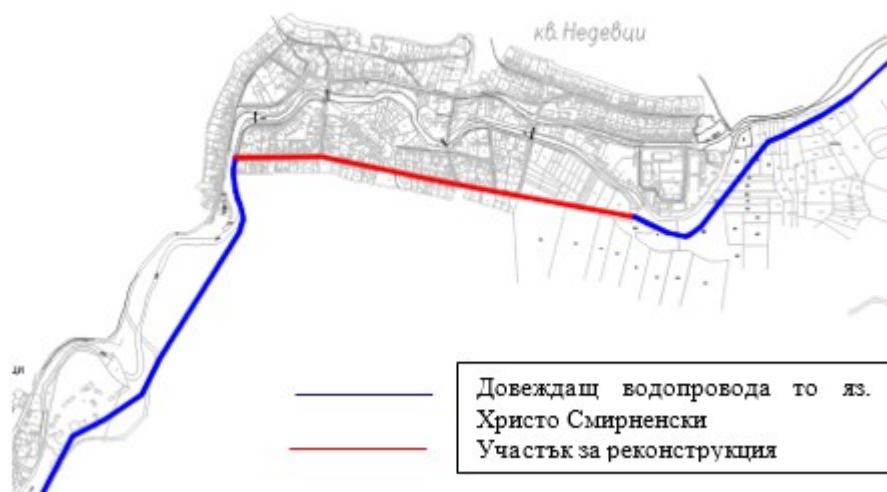
Фигура 3. Схема на детайлните варианти за реконструкция на участък от довеждащ водопровод от яз. Христо Смирненски до ПСПВ Киселчова могила – в участък преминаващ през кв. Недевци, гр. Габрово
