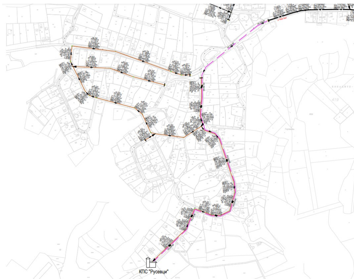
Фигура 9. Схема на нова битова канализация в кв. Русевци, агломерация Габрово
